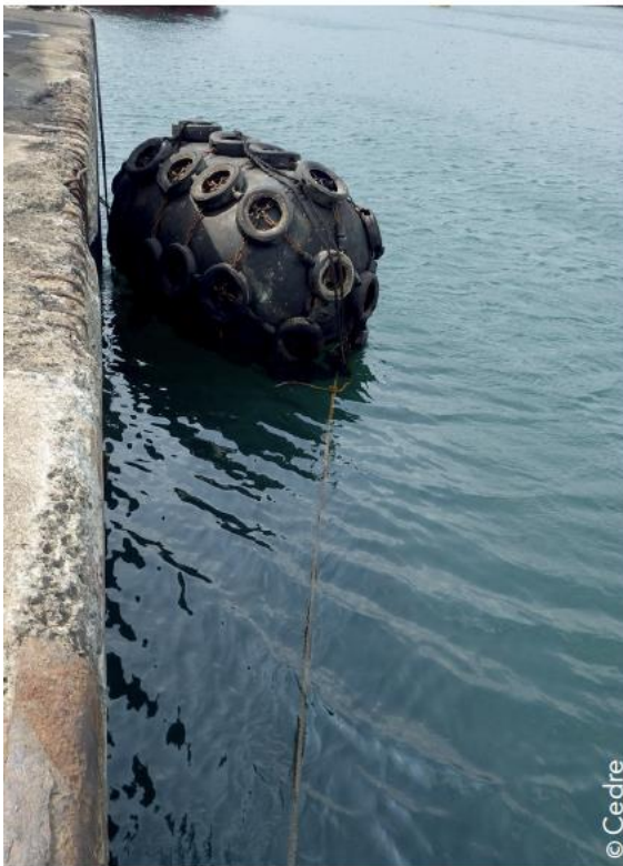
Image : Garde-boues Yokohama utilisés pour permettre l'approche entre deux navires
