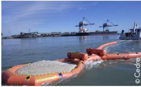
Image Confinement dynamique avec un Current Buster
