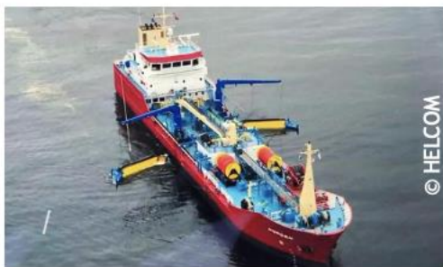
Image : Navire citerne équipé par l'AESM, disposant d'un équipement d'intervention en matière d'hydrocarbures
