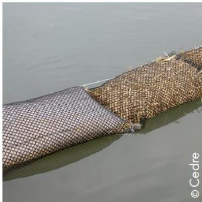
Image : Rampe sur mesure en filets et sorbants pour un déversement de stéarine de palmier
