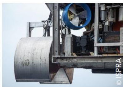
Image : Échantillonneur à pince monté sur un ROV de Classe II
