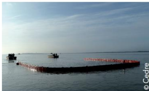
Confinement dynamique avec des rampes gonflables conventionnelles configurées en « U ».
