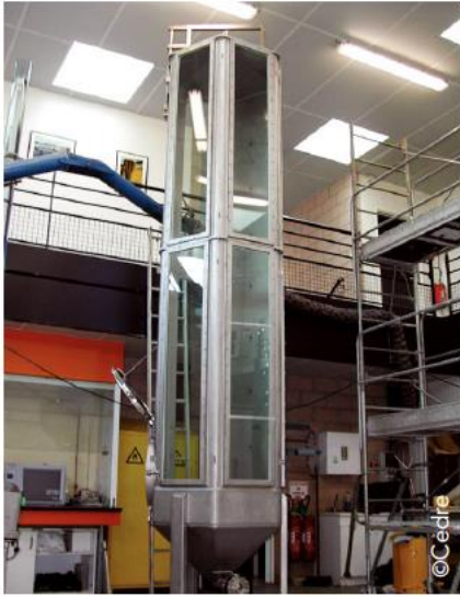
Image : Colonne d'expérimentation étudiant le comportement d'un produit chimique (ou hydrocarbure) alors qu'il s'élève ou plonge dans la colonne d'eau
